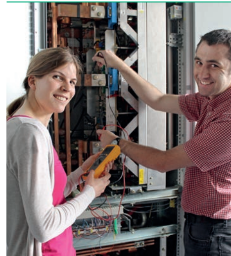
Abb. 1: Dipl.-Ing. Teresa Bertelshofer und Dr.-Ing. Michael Gleißner bei Messungen an einem Wechselrichter in der Versuchshalle des Lehrstuhls für Mechatronik (Foto: Christian Wiffler).
