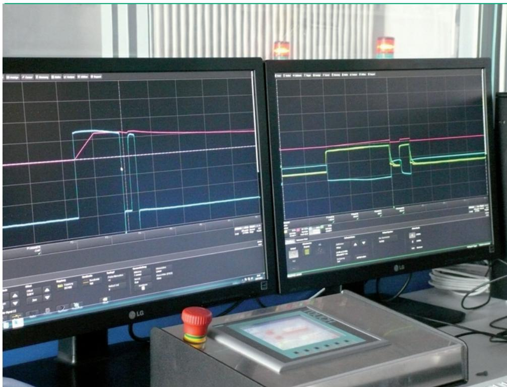
Abb 4: Steuerstand eines Testgerätes für Hochleistungshalbleiter am Zentrum für Energietechnik (ZET).
