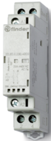
Abb. 2.8: Installationsschütz finder 22.32.0.230.4520 Schütz 1 Schließer, 1 Öffner 230 V/DC, 230 V/AC 25 A [12]
