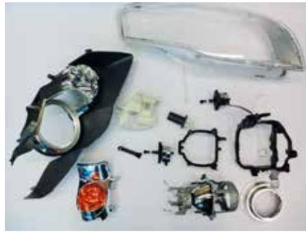
Bestandteile eines LED-Scheinwerfers mit Kurvenlicht
